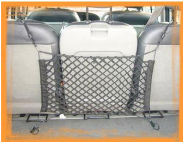
Le reti a sacco si possono installare sia in conformazione standard sia utilizzando le due prolunghe in dotazione per raggiungere punti di ancoraggio più lontani (p. es. montanti appoggiatesta – vedi lato - o viti laterali fissaggio mensole cappelliera – vedi sopra) per sfruttare fori esistenti. In questo caso le dimensioni riportate sul listino possono essere aumentate di circa 10-15 cm in altezza e di 20-25 in larghezza relativamente alla quota superiore.
